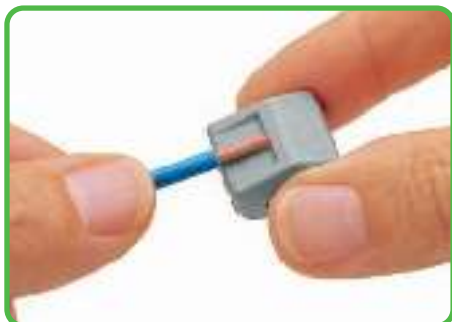
Снимите изоляцию проводника на длине 9 – 10 мм
