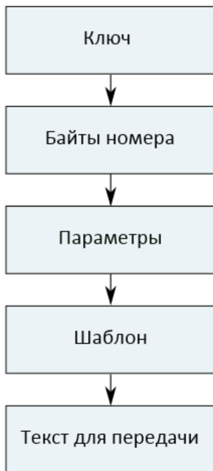
Рисунок 10. Схема преобразования ключа
