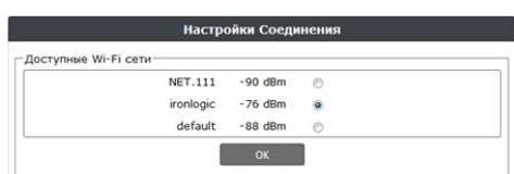
Для выбора сети необходимо выделить нужную сеть и нажать кнопку OK. При этом название Wi-Fi-сети автоматически отобразится в настройках. Если сеть не ведёт вещания своего имени, то имя сети следует ввести вручную в поле Сеть (SSID). При использовании шифрования необходимо ввести ключ шифрования:
