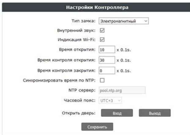
**Тип замка:** выбор типа замка Электрозашёлка, Электромагнитный, Электромеханический. Если тип замка настроен управляющей программой, то изменение типа замка невозможно до сброса в заводские настройки с помощью Web-интерфейса или перемычки (положение 2, см. стр. 50), а поле “Тип замка” отображается название настроенной точки прохода.
