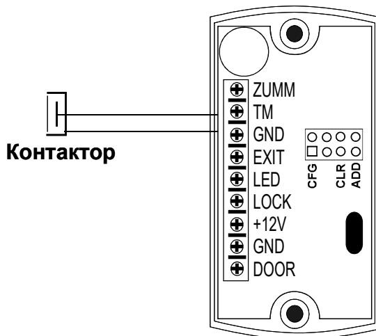
Рис.6 Подключение контактора
