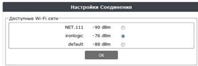
**Тест сети:** проверка возможности подключения с текущими значениями SSID и пароля. Тем не менее, при правильном пароле роутер может отказать в подключении, поскольку может быть настроен на проверку MAC-адреса устройства.
