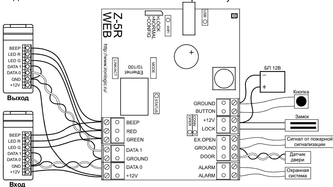
Подключение внешних считывателей по протоколу Wiegand:
