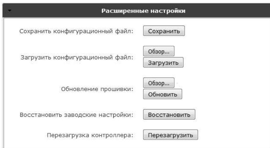
**Сохранить конфигурационный файл:** сохраняет выполненные настройки контроллера в файл на устройстве, с которого производится настройка.
