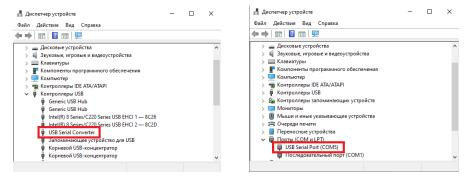
Если при подключении настольного считывателя (адаптера, конвертера) к компьютеру операционная система Windows обнаружила новое устройство, но не смогла установить драйверы, их нужно установить вручную.
