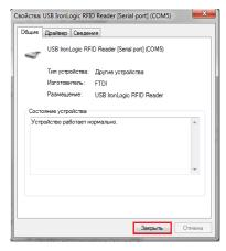
После проделанных операций считыватель (адаптер, конвертер) установится в системе. В разделе «Контроллеры USB» должен появится «USB IronLogic RFID Reader (Z397-Guard USB<->485)». В разделе «Порты СОМ и LPT» должен появится «USB IronLogic RFID Reader [Serial port] (COM...) (Z397-Guard USB<->485 [Serial port] ](COM...))».
