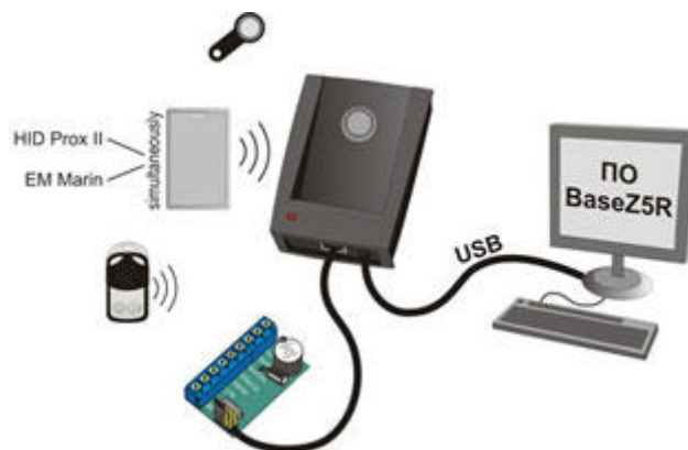
Рис. 8. Схема подключения адаптера Z-2 (мод. E HTZ RF) к контроллеру и компьютеру
