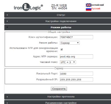
В случае выбора режима работы «Клиент» модуль связи сам будет регулярно пытаться установить соединение с управляющей программой.
