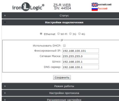
В случае использования в локальной сети DHCP-сервера сетевые настройки получаются контроллером автоматически.
