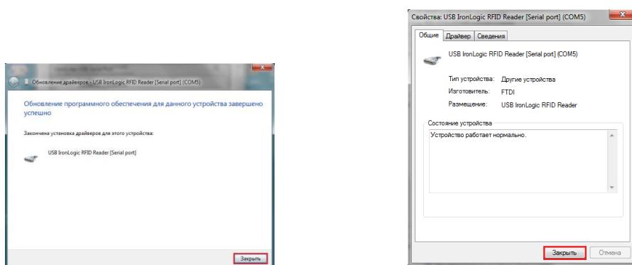
После проделанных операций считыватель (конвертер) установится в системе. В разделе «Контроллеры USB» должен появится «USB IronLogic RFID Reader (Z397-Guard USB<->485)». В разделе «Порты COM и LPT» должен появится «USB IronLogic RFID Reader [Serial port](COM...) (Z397-Guard USB<->485 [Serial port] )(COM...)».
