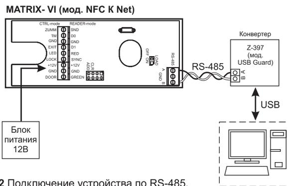
Рис.2 Подключение устройства по RS-485.
