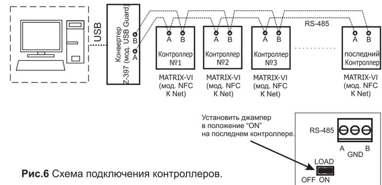
Рис.6 Схема подключения контроллеров.
