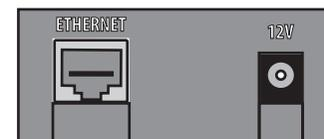
**ETHERNET** - разъем RJ45 для подсоединения к локальной сети. Для подключения используется стандартный патч-корд с прямым порядком обжима.
