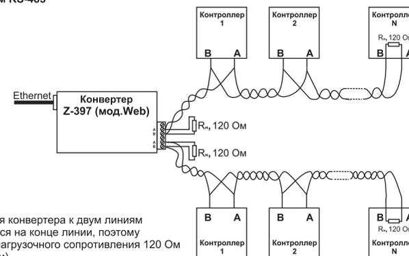
Пример схемы подключения конвертера к двум линиям RS-485. Конвертер находится на конце линии, поэтому необходимо подключение нагрузочного сопротивления 120 Ом (входит в комплект поставки).
