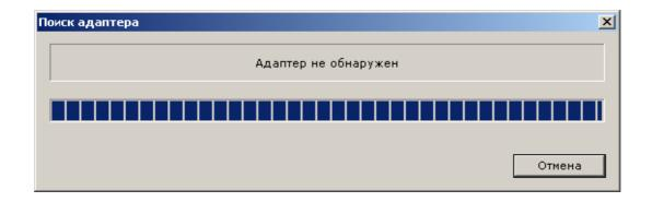
В этом случае необходимо закрыть данное окно, проверить подключение адаптера **RF1996** к компьютеру и повторить попытку соединения адаптера **RF1996** с программой.
