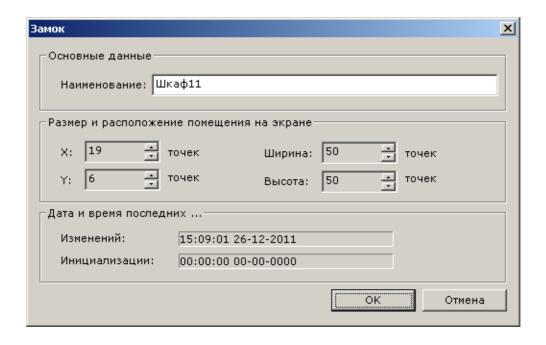
В данном диалоге можно изменить режим работы, наименование и расположение на экране шкафчика. Так же отображается дата и время инициализации шкафчика и дата и время последней инициализации шкафчика.
