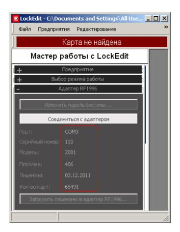
Далее программа проверит версию Firmware адаптера RF1996 и при необходимости вызовет обновление Firmware (см. пункт 2.6) и автоматически загрузит пароль системы в адаптер.
