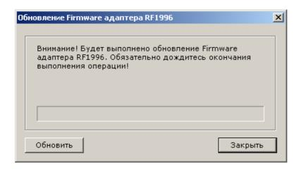
Необходимо нажать кнопку **Обновить** для обновления Firmware адаптера. Прерывать процесс обновления Firmware не рекомендуется. После окончания обновления Firmware программа автоматически заново установит соединение с **адаптером RF1996** и загрузит пароль системы в адаптер.
