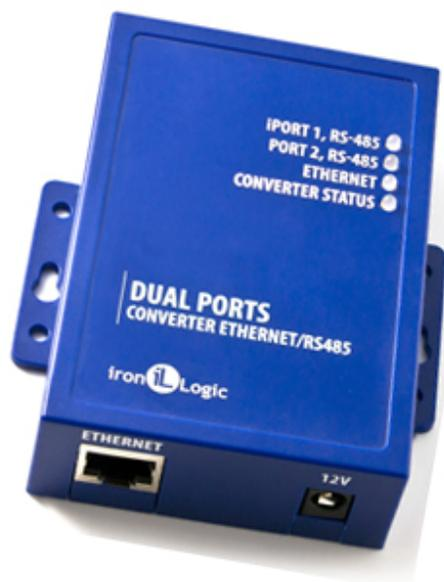
Обеспечивает подключение коммуникационного интерфейса контроллеров (RS485) в компьютеру по TCP/IP без создания виртуального COM-порта.
