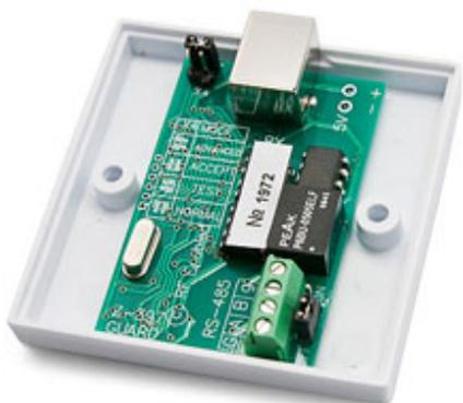
Обеспечивает преобразование коммуникационного интерфейса контроллеров (RS485) в интерфейс компьютера (USB) и далее, с помощью драйвера, в виртуальный COM-порт. Интерфейс RS485 – позволяет подключать устройства на расстояниях около одного километра. Питание конвертера осуществляется по кабелю USB от компьютера.
