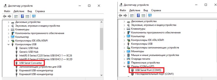
Если при подключении считывателя (конвертера) к компьютеру операционная система Windows обнаружила новое устройство, но не смогла установить драйверы, их нужно установить вручную.
