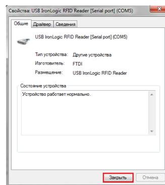
После проделанных операций считыватель (конвертер) установится в системе. В разделе «Контроллеры USB» должен появиться «USB IronLogic RFID Reader (Z397-Guard USB<->485)». В разделе «Порты COM и LPT» должен появиться «USB IronLogic RFID Reader [Serial port](COM...)(Z397-Guard USB<->485 [Serial port] )(COM...))».
