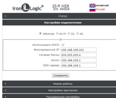
В случае использования в локальной сети DHCP-сервера сетевые настройки получают контроллером автоматически.
