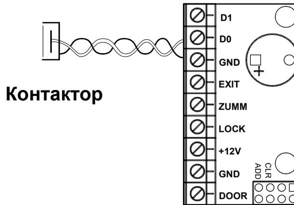
Рис. 4 Подключение контактора
