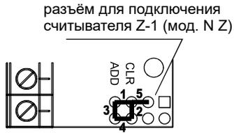
Рис.2 Положения перемычки
