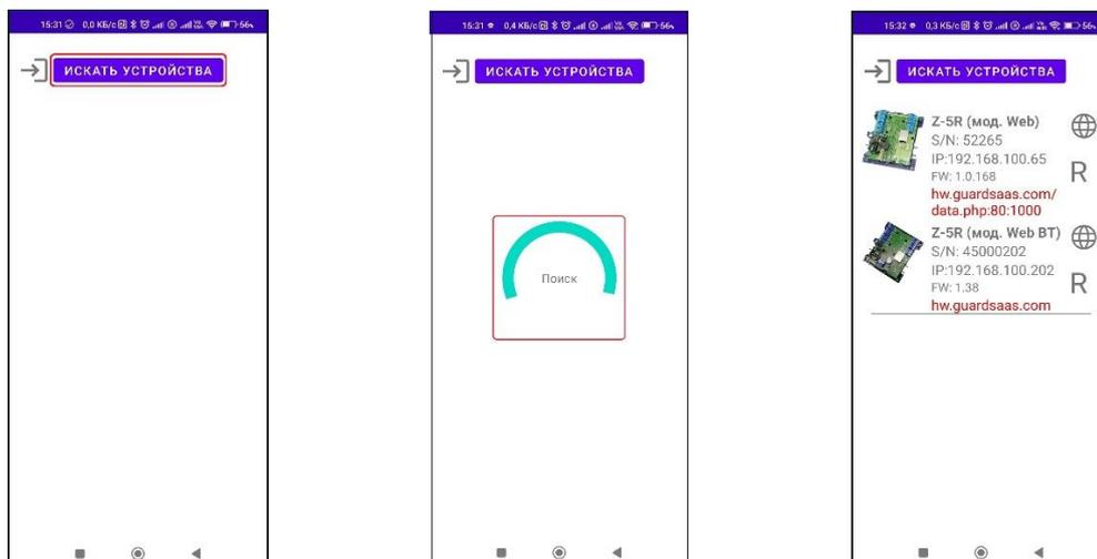
После окончания поиска на экране появятся все найденные конвертеры (IP-контроллеры). На выбранном конвертере (IP-контроллере) нужно кликнуть по кнопке «R» для перевода его на сервер RU и в появившемся окне «Изменение сервера» нажать на кнопку «Изменить».
