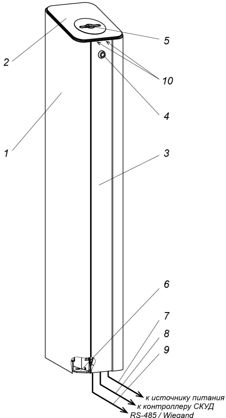
**Рисунок 2. Устройство картоприемника:**
