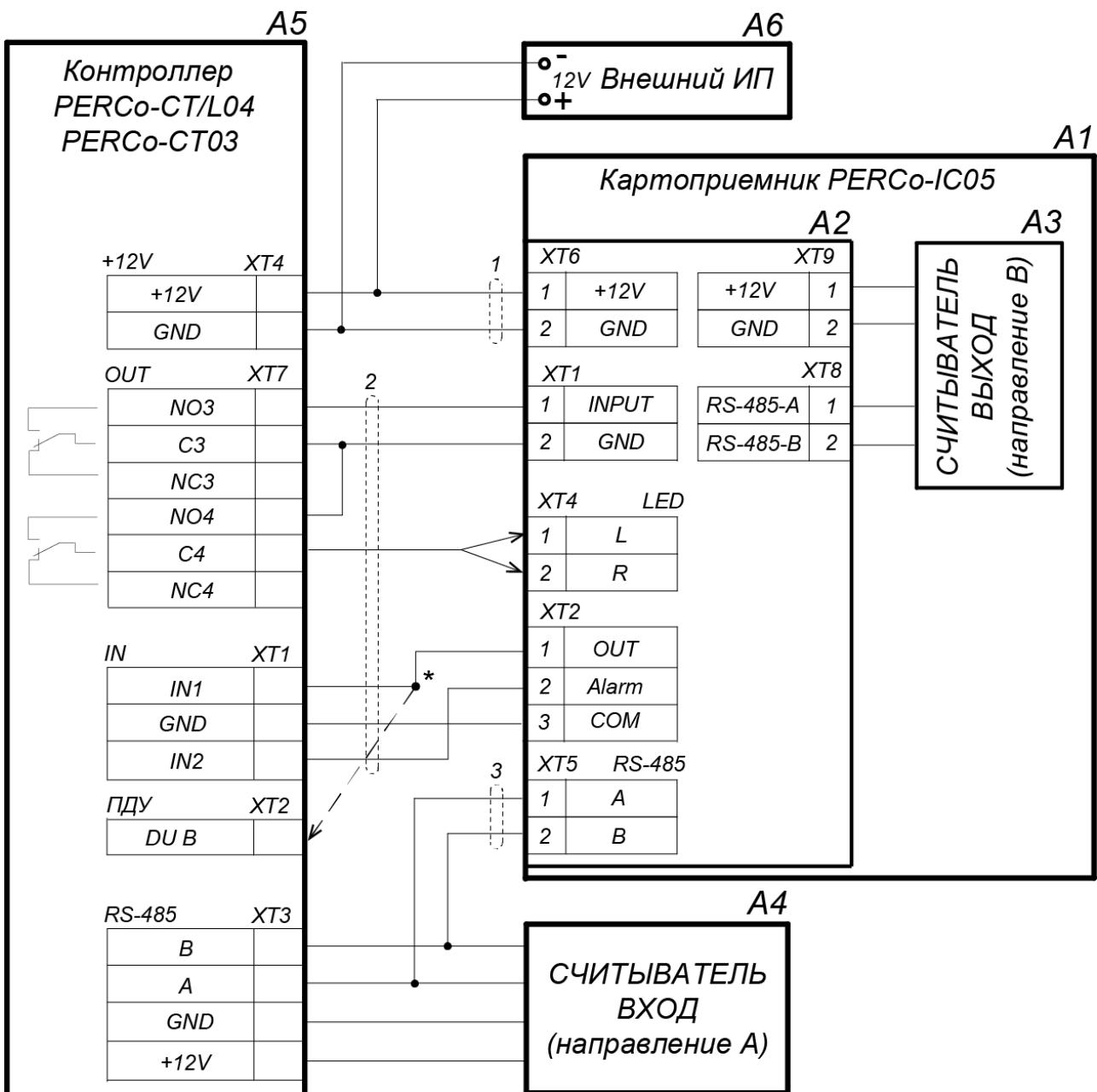
\* Для контроллеров PERCo-CT/L04 с версией прошивки x.0.0.19 и ниже выход картоприемника «Карта изъята» подключается параллельно ПДУ ко входу управления контроллера DU B (или DU A в зависимости от направления прохода). Этот же метод подключения может использоваться в том случае, если все дополнительные входы контроллера заняты.
