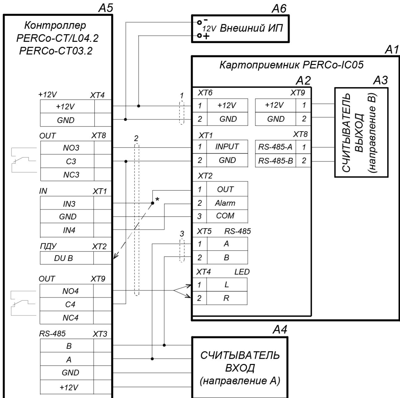
**Рисунок 7. Схема подключения картоприемника к контроллеру PERCo-CT/L04.2, PERCo-CT03.2 по интерфейсу RS-485 (перечень элементов приведен в табл. 2)**
