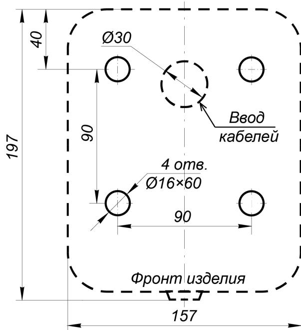
**Рисунок 5. Схема разметки для установки картоприемника**
