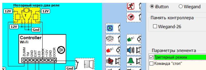
При активации режима «Команда “стоп”» перед каждым включением на открытие или закрытие одновременно включаются оба сигнала, что для некоторых блоков управления означает команду «стоп». В случае поддержки контроллером ворот, команда "стоп" имитируется одновременным срабатыванием управляющих сигналов. При подключении реле следует подключить параллельно обмоткам защитные диоды.
