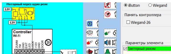
**Ввиду того, что запирание моторного замка при открытой двери может привести к его поломке, автоматическое запирания по истечении какого-либо времени нет, только по датчику двери или по времени, если дверь не открыли.**
