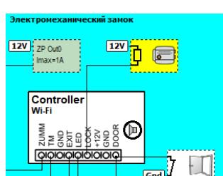
Если замок использует маломощную катушку и позволяет длительно подавать напряжение, то напряжение будет подано постоянно на время разблокировки. Для этого нужно установить флаг «Допустима длительная подача напряжения».
