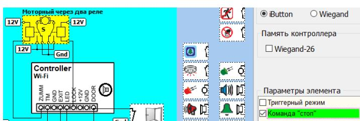
Время, на которое выдается активный уровень – это время открытого состояния замка, которое может быть ограничено с помощью датчика крайнего положения. При срабатывании датчика без команды контроллера выдаются сообщения, с помощью которых можно проверить правильность подключения датчиков.
