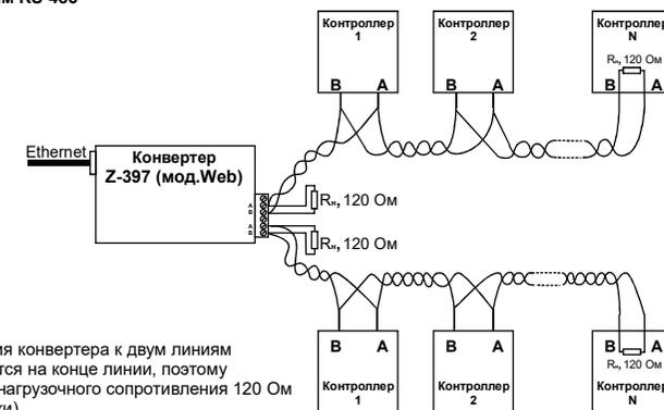
Пример схемы подключения конвертера к двум линиям RS-485. Конвертер находится на конце линии, поэтому необходимо подключение нагрузочного сопротивления 120 Ом (входит в комплект поставки).
